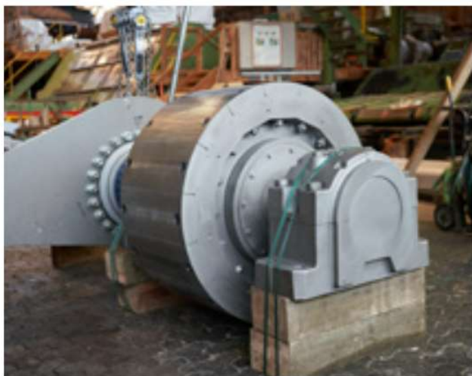
Bereit zur Montage, eine Walze mit angeflanschten 22 kW Getriebemotor.
