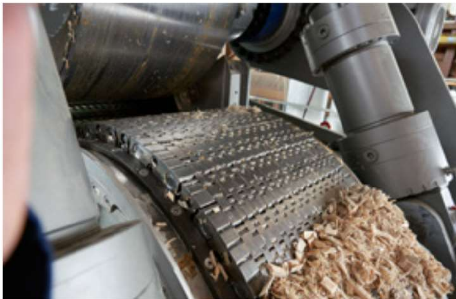
Die Walzen und die Kette bilden das Herzstück der Hackschnitzelquetsche.
