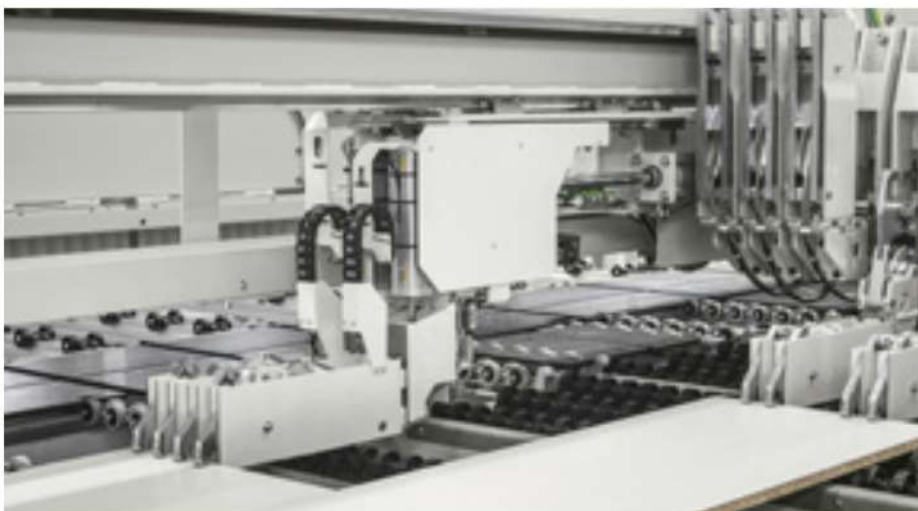
Flexcut 1D: Geteilter Positionierschieber für die Ausführung komplexer Schnittmuster in kürzester Zeit.
