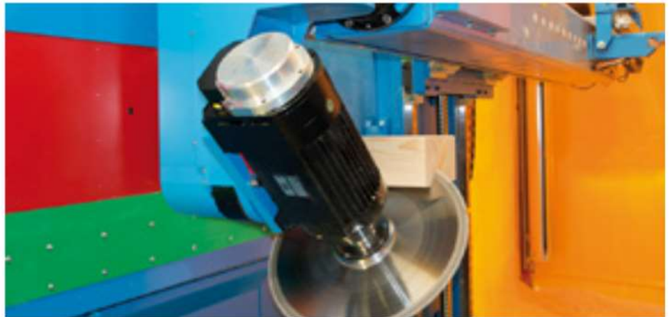
Kehlsparren werden ausgesägt.
