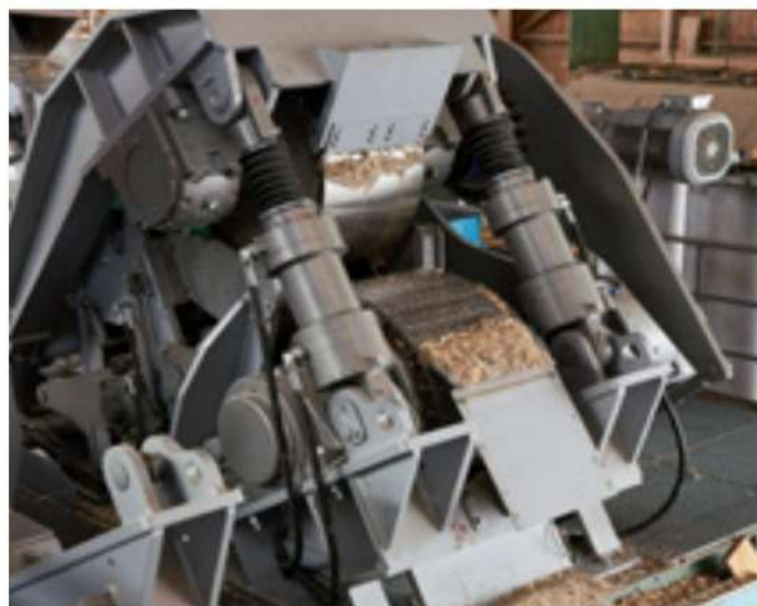
Das 17 t Kraftpaket hat einen Flächenbedarf von 3 × 4 m ohne Material Zu- und Abführung.
