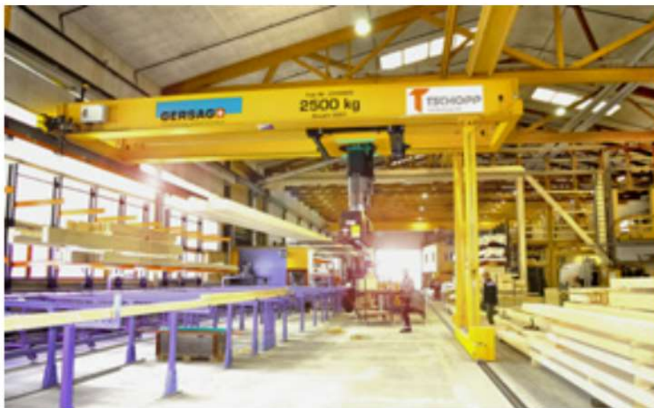
Der Simi Stapelkran macht die ganze Hallenlänge zugänglich.
