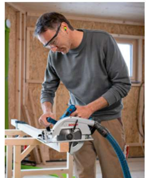
Die GKS 18V-70 L Professional ist die erste Akku-Handkreissäge von Bosch mit Sägeblatt links. Sie ist für Linkshänder konzipiert und für Handwerker, die lieber links sägen. Foto: Bosch
