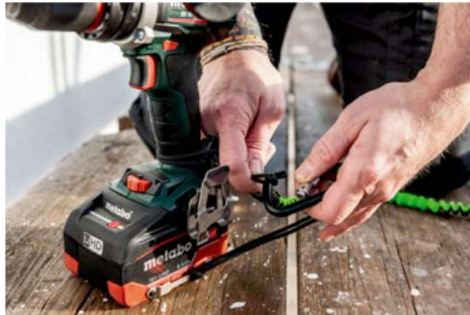
Akku sichern leichtgemacht: Einfach die Schleife der Akku-Sicherungs-verbinding durch den Sicherungsbügel am Akkupack ziehen und den Karabiner an der Extra-Schleife am Werkzeug-Sicherungs-gurt einhaken. Bild: Metabo
