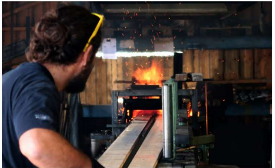
Die von MOCOPINUS betriebene Beflammungsanlage gewährleistet eine exakte Steuerung aller Prozessparameter. Das sorgt für gleichbleibend hohe Qualität und ein reproduzierbares Ergebnis bei jeder Behandlungsart. Fotos: Mocopinus
