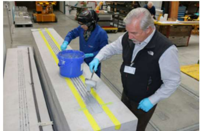
Epoxidharz als Kleber fuer CFK-Lamellen: Empa-Forscherin Niloufar Moshiri und Industriepartner Martin Hueppi bei den Vorbereitungen. Bild: Empa
