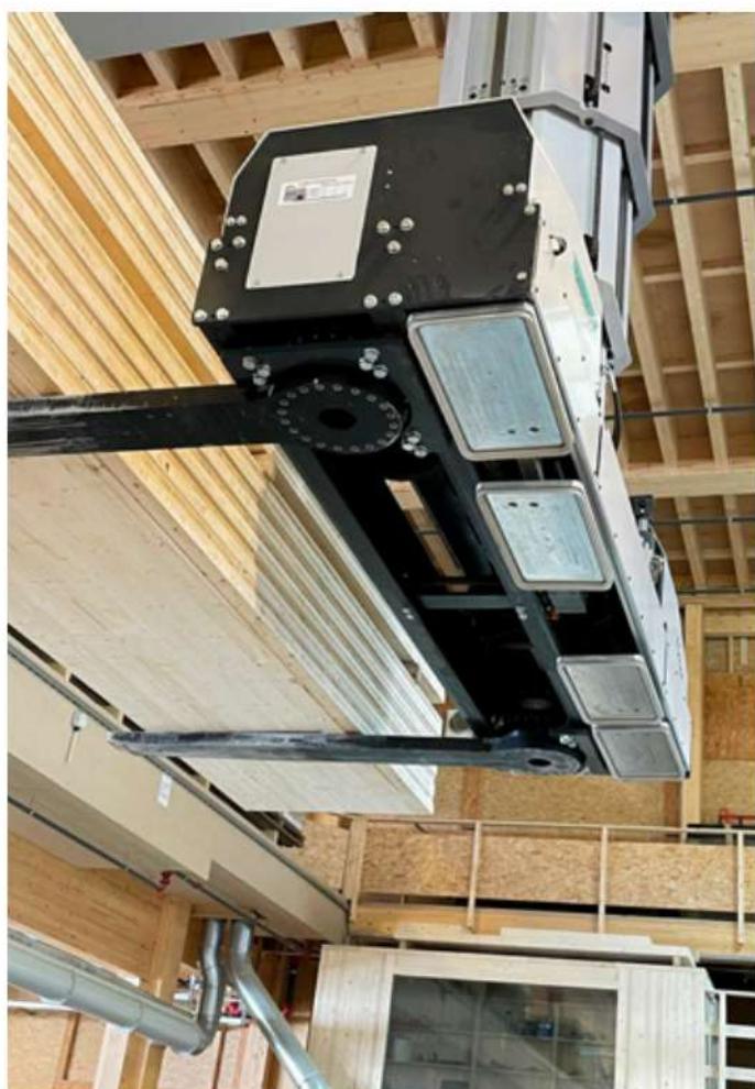
Gabelzinken können um 90 Grad eingefahren werden. Fotos: Gersag
