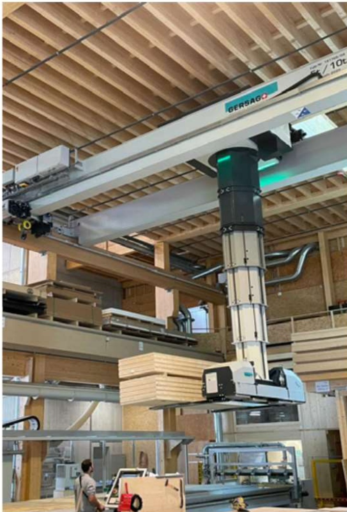
Im Gabelbetrieb transportiert der Marco-Stapelkran bis 5 Tonnen.
