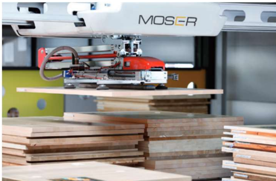
Vollautomatisches Plattenlager für Moser Premium Massivholzplatten. Bilder: Moser
