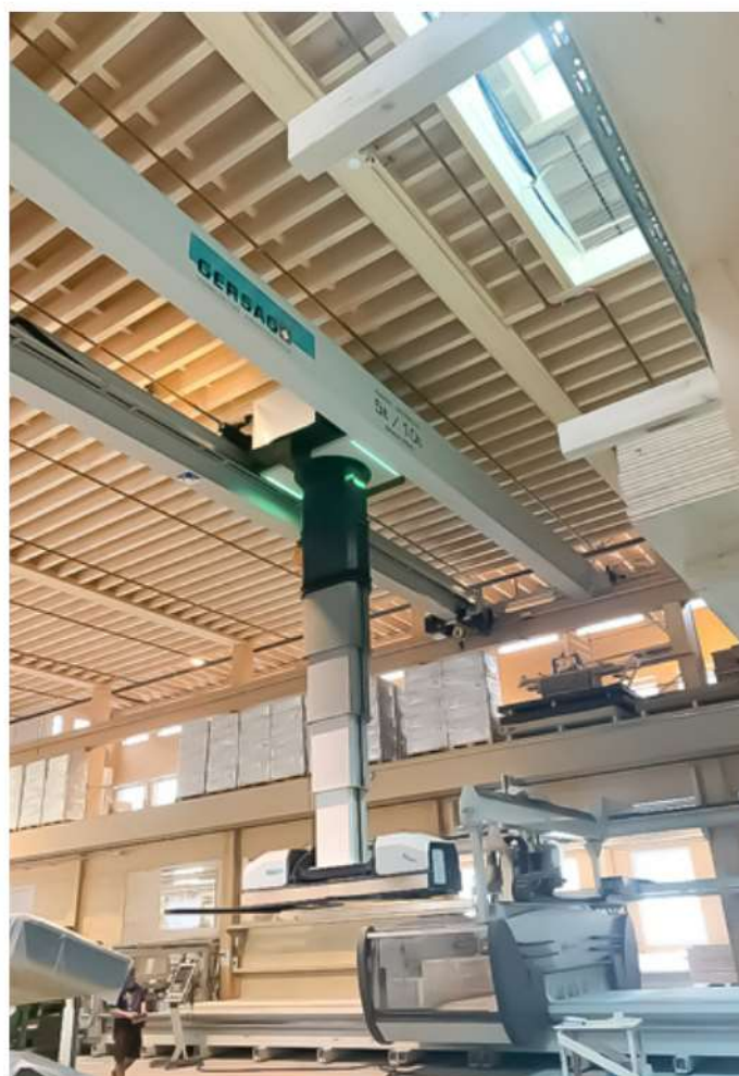
Der Marco-Stapelkran kann Einzelplatten mit der Vakuumtraverse aufnehmen.
