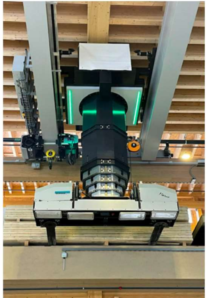
Kran Marco fährt die definierten Lagerplätze halbautomatisch an.
