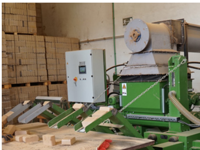
Anlagen von RUF pressen Holzspäne und andere Holzreste zu hochwertigen Briketts. Bilder: RUF Maschinenbau GmbH & Co. KG
