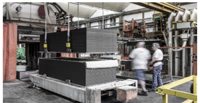
Erst im gepressten Zustand erhält Faserzement seine aussergewöhnliche Festigkeit.
