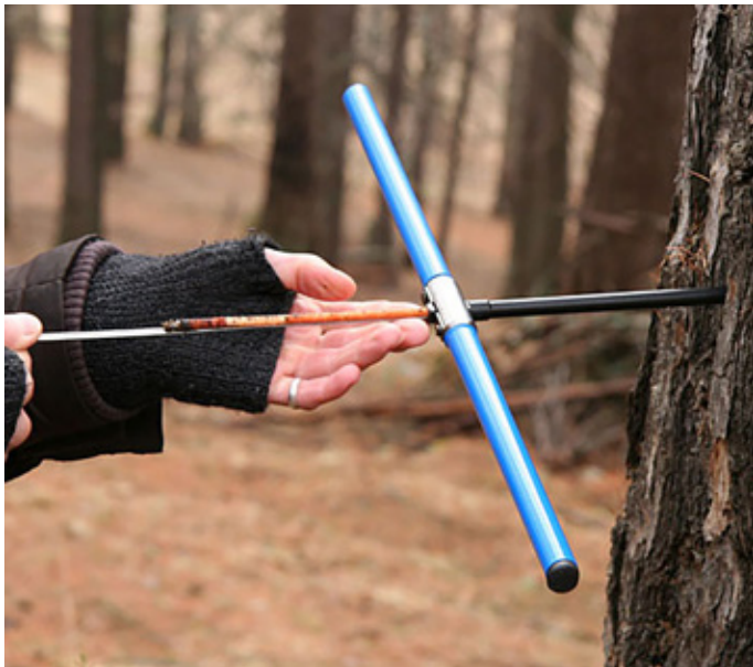
Jahresringkerne werden mit speziellen Zuwachsbohrern entnommen.
