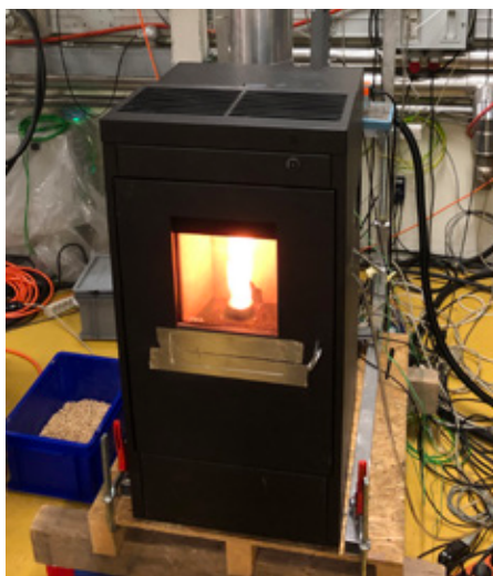
Das Team aus Forschenden der FHNW hat mit zwei Prototypen von Pelletöfen gearbeitet: Mit dem ersten wurde das Konzept erprobt, während der zweite (Bild) in seiner Konstruktionsweise schon auf eine spätere Serienfertigung ausgerichtet ist. Foto: FHNW
