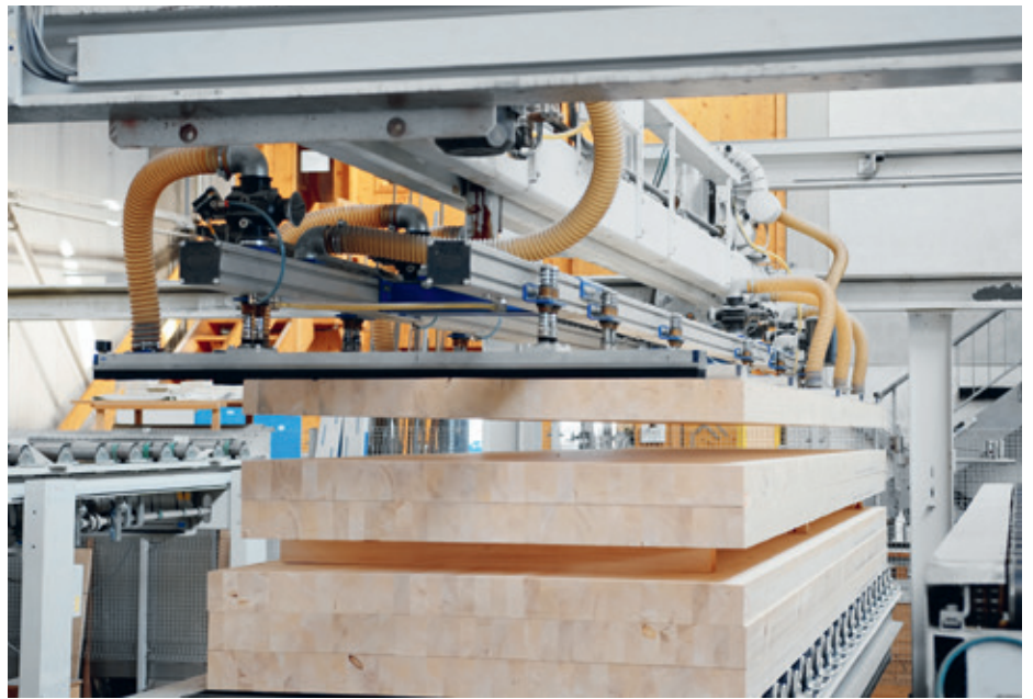
Nach dem Schliiff sowie stirnseitigem Kappschnitt werden die Leimholzplatten automatisch paketweise gestapelt. Bilder: Toma Holz
