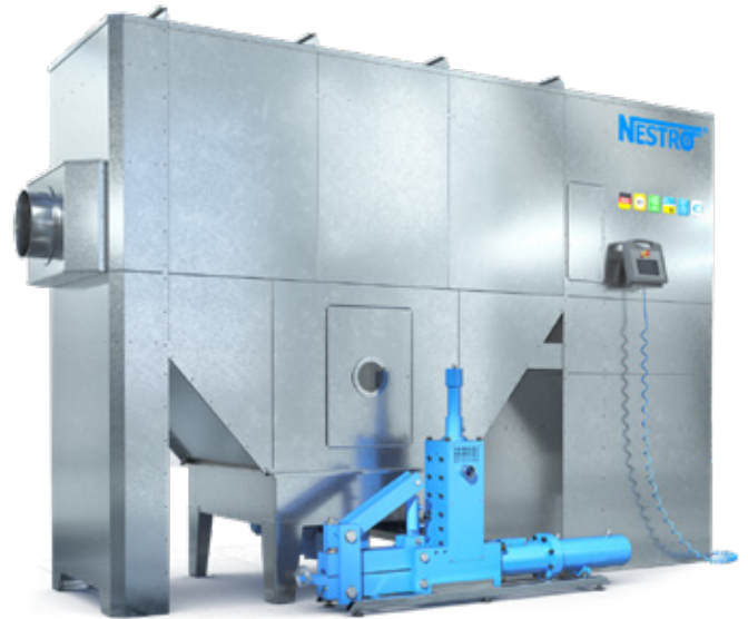
NESTRO® Entstauber NE 300 J mit Übergang auf Brikettierpresse NBP 60.
