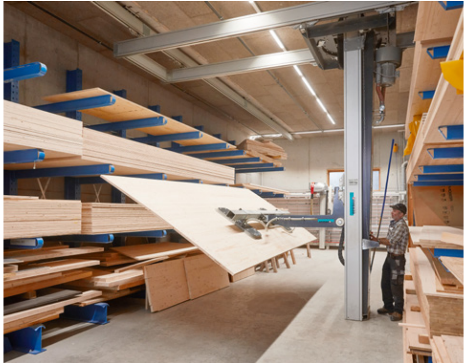
Die Brawand Zimmerei setzt auf das Regalbediengerät rund um die Lagerplätze und Plattensäge.
