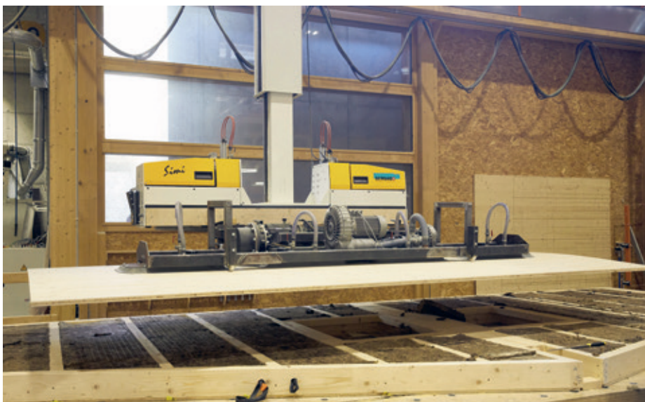
Der multifunktionale Simi-Stapelkran im Hebeeinsatz.
