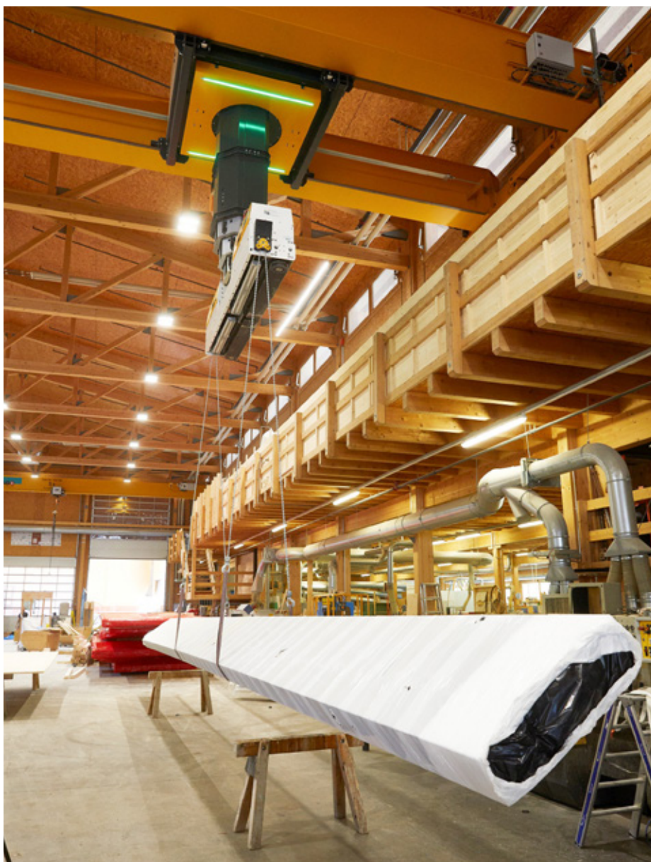
Mit der Wendevorrichtung lassen sich grosse Lasten wenden und transportieren.
