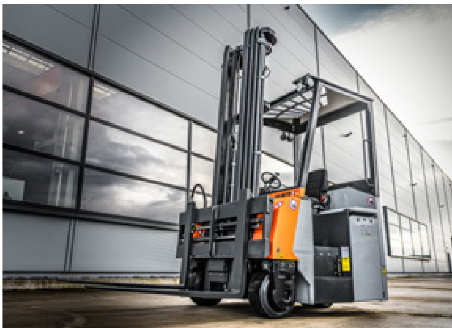
Durch den Mischeinsatz als Front- und Seitentapler ist der neue FluX 30 (3 Tonnen) prädestiniert für die Holzindustrie und holzverarbeitende Unternehmen. Bilder: © Hubtex
