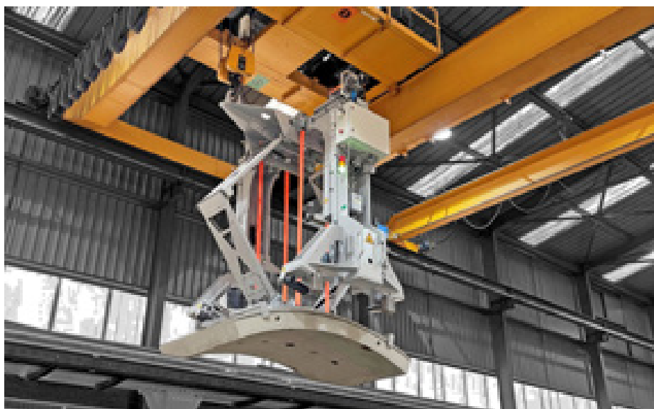
Das Gleiche System wird in der Tübing Fabrikation bis zu einer Nutzlast von 5 t eingesetzt (Tübing Herstellung bei Marti Tunnelbau AG für den Zugangs-Stollen Gotthard Süd).
