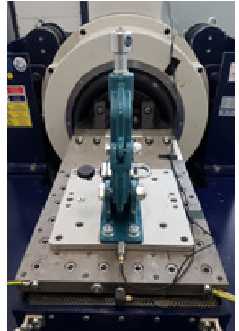
Erschütterungsprüfung von mechatronischen Hangschlössern und deren Schlüsseln im Prüfinstitut Schlösser und Beschläge Velbert (PIV).
