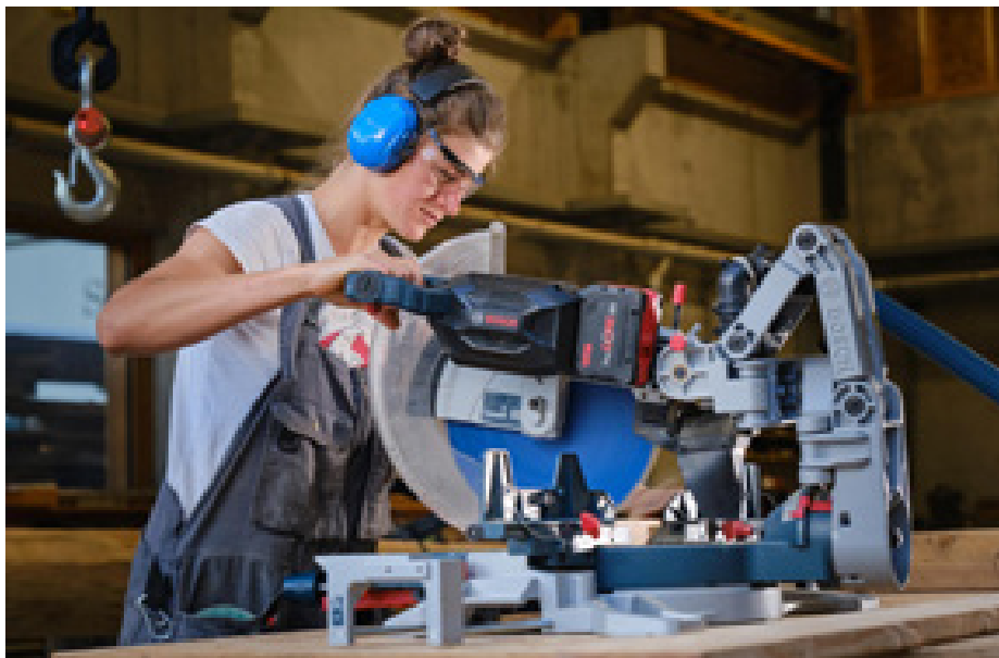
Beatrice Schaller längt 180 Millimeter starke Holzbalken in verschiedenen Winkeln ab.
