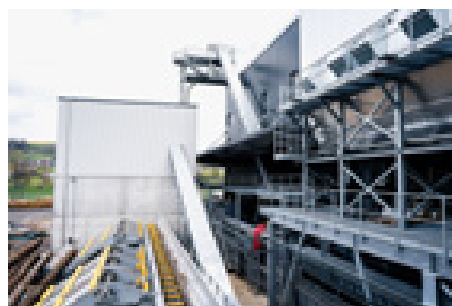
Die in der Box gesammelten Rindenabfälle werden ebenfalls zum Pelletwerk gefördert.
