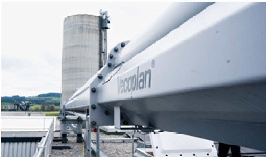
Ausserhalb des Gebäudes sorgen Kratzketten- und Rohrgutförderer von Vecoplan für den staubfreien Transport des aufbereiteten Materials bis zum Pelletwerk.
