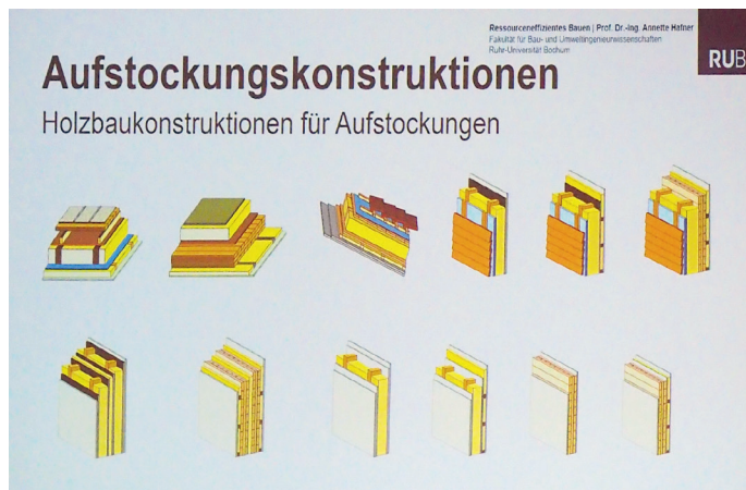
Verschiedene Konstruktionen bei Aufstockungen.
