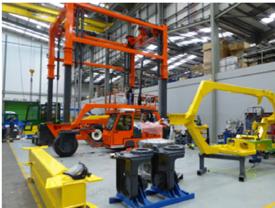
Portalhubstapler während der Herstellung. Dieser kann schwere, gefüllte Schiffscontainer heben und an den richtigen Ort befördern. Bilder: Martin Binkert
